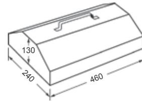
箱子採鐵板烤漆製成，分兩排每側可裝13捲標誌，供可裝26捲，外面以透明壓克力護蓋，可直接目視所需號碼。
